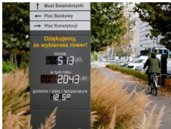
Ilustracja 27: Panel informacyjny na pętli indukcyjnej w Warszawie. Źródło: https://rowery.um.warszawa.pl
