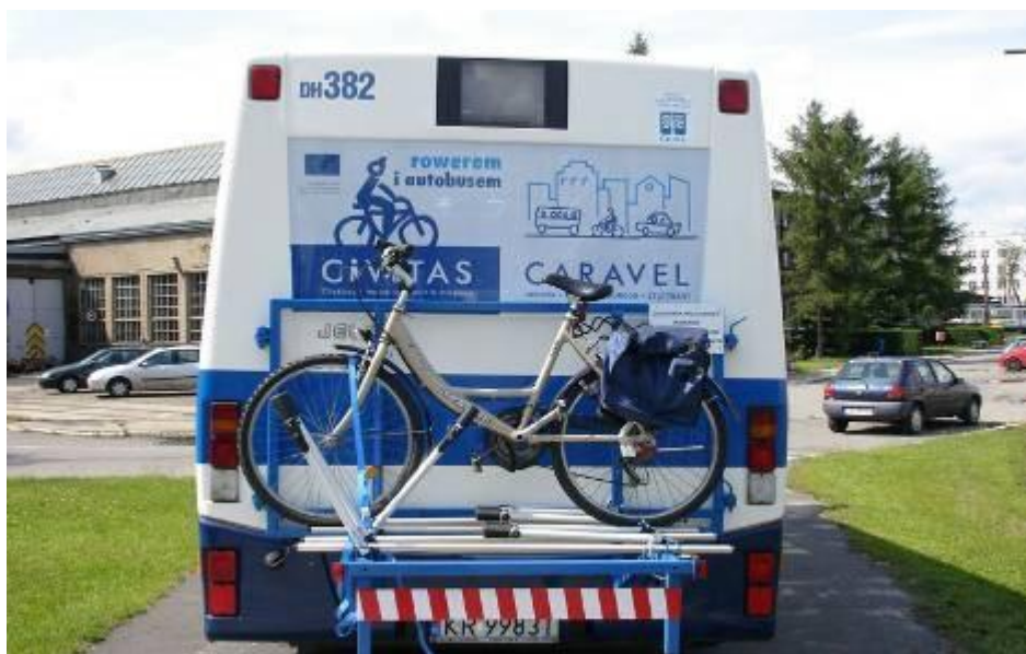
Ilustracja 16: Przykład bagażnika rowerowego zamontowanego z tyłu autobusu
