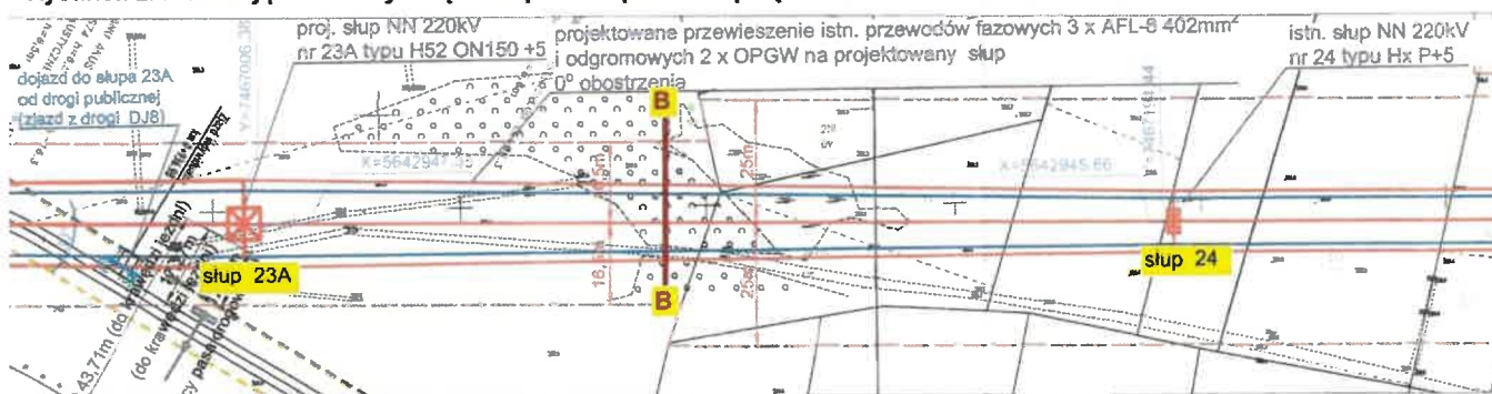
Rysunek 2. Przekrój pomiarowy natężenia pola-E i pola-M w prześle 23A - 24 linii 220 kV Kielce - Kielce Piaski
