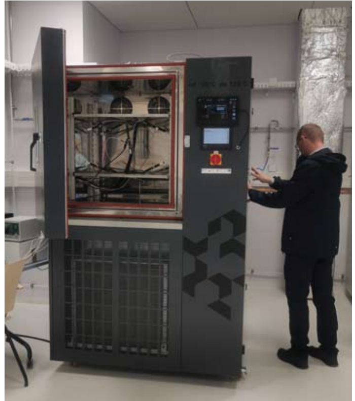
Komora klimatyczna o zakresie temperatur od -90°C do 120°C
