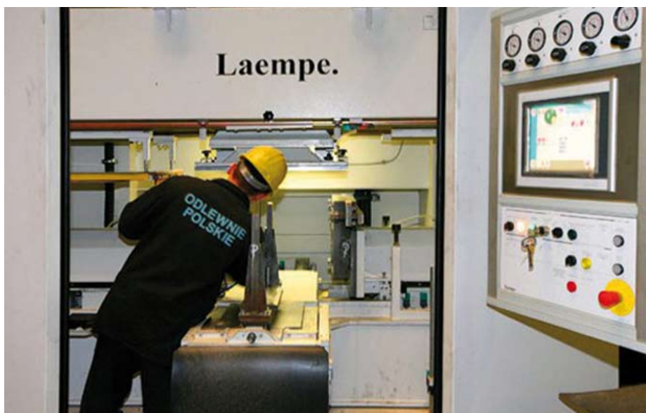
Wykonywanie rdzeni na strzelarkach automatycznych Laempe
