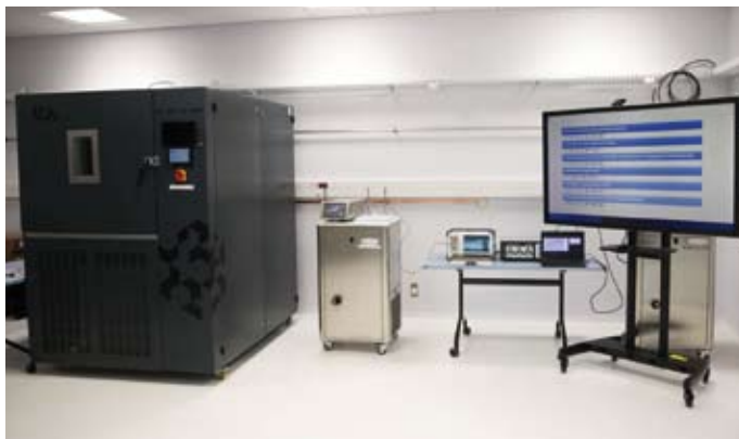
Komora klimatyczna o zakresie temperatur od -70°C do 180°C
