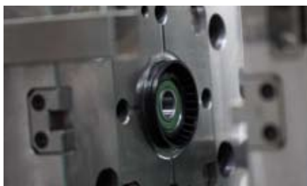
Gotowa rolka w gnieździe formy wtryskowej
